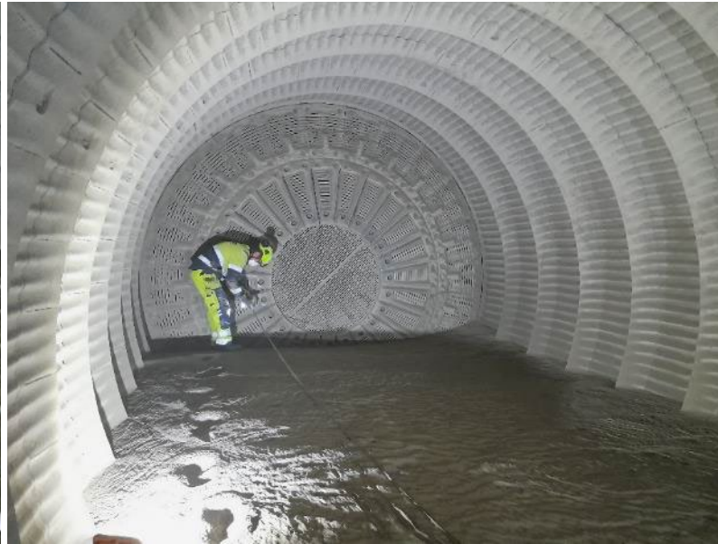
Kammare 2: 20-50 mm i diameter Större kontaktyta och ger effektivare malning till finare fraktioner
