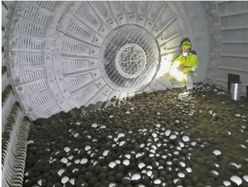
Kammare 1: 60-90 mm i diameter Bra på att mala större partiklar – krossar materialet
