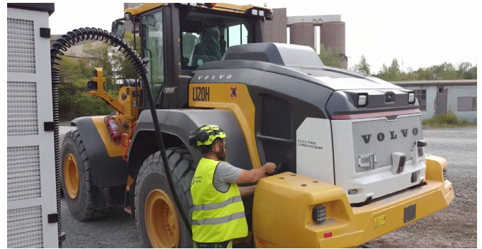
Den nya elektriska hjullastaren laddas regelbundet.
