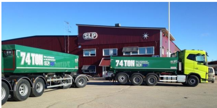
Figur 27: Sidotippande 74-tons ekipage med kort, fem-axlat släp (Källa: SLP)
