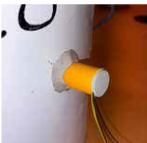
1. Borrhålsmätning med tätning mot plåt.
