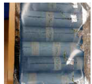
4. Efterkontroll av läckage i 100% RF.
