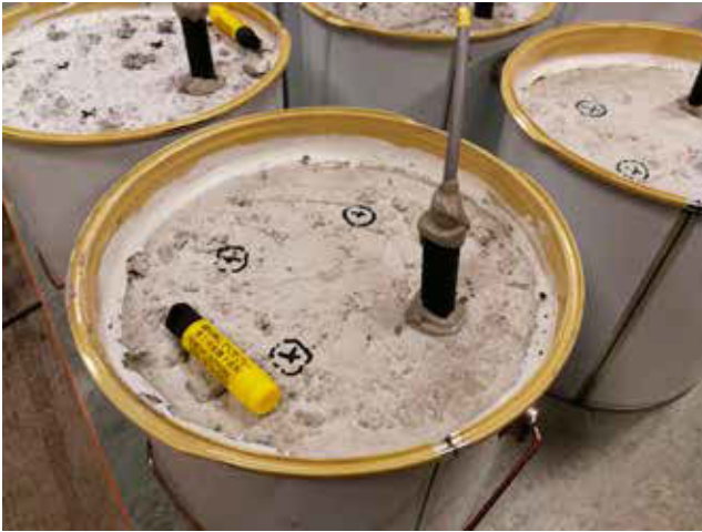
Figur 1a. RF-mätning med givare Vaisala HMP40S monterad i provkropp under pågående försök. Givarnas placering vid påföljande tre mätstillfällen har markerats på betongens yta med inringade kryss. Anslutning mellan plåthinkens mantelyta och betongen förseglades.
